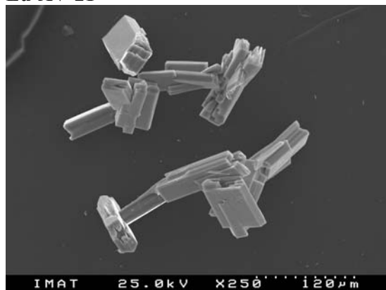
Figura 6.8 - Imagens de microscopia electrónica de varrimento dos cristais de Ln-AV-21.
