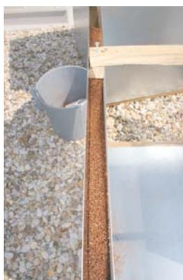
Figura 2: Preparação de um protótipo para estudo do comportamento térmico de um espaço isolado térmicamente por um compósito de cortiça e parafina.
