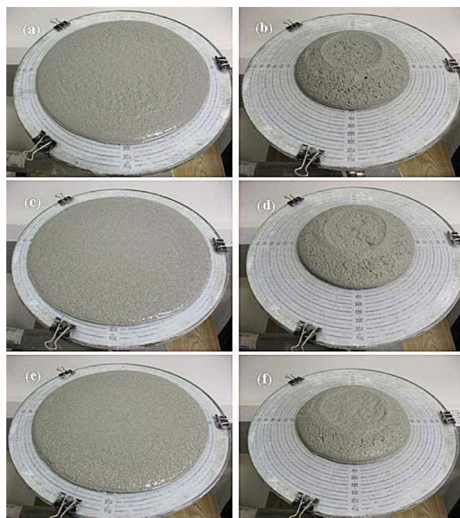
**Figure 1:** Mortar with distinct formulations flow test on testing table. Ensaios de espalhamento em disco da mesa de espalhamento de argamassas com formulações distintas.
