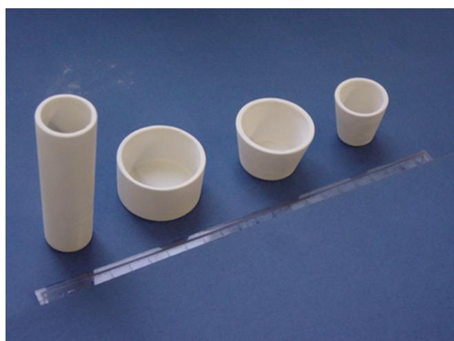
**Figure 1:** Examples of AlN crucible prepared by slip casting from aqueous suspensions. Exemplos de cadiños de AlN preparados por barbotina a partir de suspensões aquosas.
