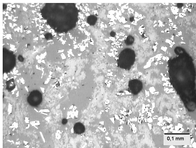
**Figure 1:** Optical micrograph of ceramic compacts prepared from bottom ash resulting from municipal solid waste (MSW) incineration after sintered at 1100°C for 2 hours (bottom ash particle size<125 µm). Fotografia, obtida por microscopia óptica, de compactos cerâmicos preparados a partir de escórias de incineração de RSU, sinterizados a 1100°C durante 2h (tamanho de partícula das escórias <125 µm).
