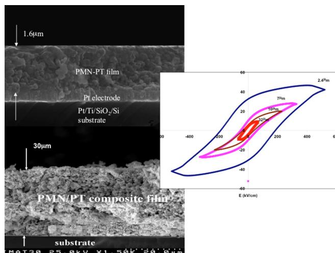
**Figure 1:** Microstructure of thick composite films of thick composite films with different thickness. Remanent polarization value with more than 30  $\mu\text{C}/\text{cm}^2$  for a 2.4  $\mu\text{m}$  thick film. Microestrutura de filmes compostos grossos de filmes espessos compósitos com diferentes espessuras. Valor de polarização remanescente com mais de 30  $\mu\text{C}/\text{cm}^2$  para um filme de 2,4  $\mu\text{m}$  de espessura.
