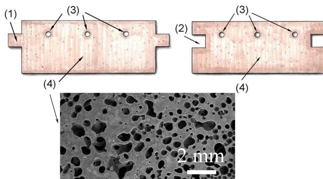
**Figure 1:** Schematic top view of Nanocellular blocks, showing male-female interlocking features (1)-(2) and utilities channels (3), and photograph of the block's outside surface (4). Esquema da vista superior de blocos Nanocelulares mostrando características de interbloqueio macho-fêmea (1) - (2) e os canais de utilidade (3) e uma fotografia da superfície exterior do bloco (4).
