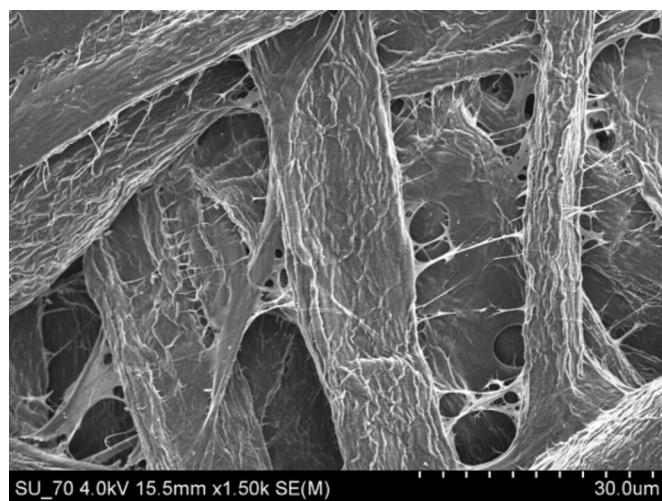
**Figure 1:** Scanning electron microscopy images of paper sheets coated in a size-press machine with formulations based on chitosan and bacterial cellulose. Imagens de microscopia eletrônica de varrimento de folhas de papel revestido em uma máquina de imprensa com formulações à base de quitosana e celulose bacteriana.
