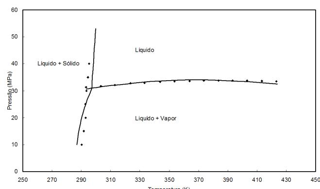
**Figure 1:** Phase envelope prediction and comparison with experimental data. Previsão do envelope de fases e comparação com dados experimentais.
