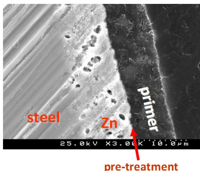
**Figure 2:** SEM cross-sectional image which shows the composition of the coating shown in Figure 1, applied to galvanized steel. Imagem de SEM em corte transversal, que revela a composição do revestimento apresentado na Figura 1, aplicado em aço galvanizado.
