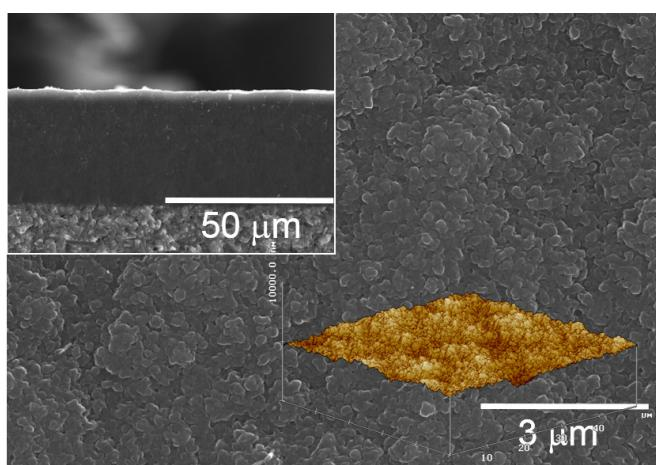
**Figure 1:** CVD nanocrystalline diamond. Diamante CVD nanocrystalino.
