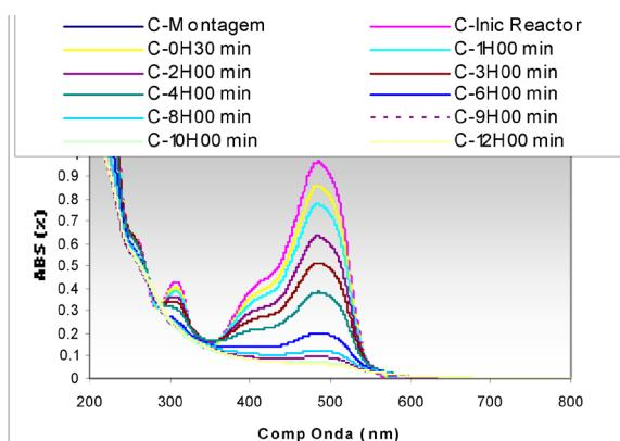
**Figure 1:** Attenuation of typical absorption band of the Orange II dye in contact with ceramic pieces upon light irradiation. Atenuação da banda de absorção típica do corante laranja II em contato com peças de cerâmica sob irradiação de luz.
