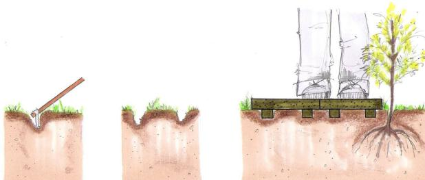
**Figure 1:** Schematic representation of manual earth removal for paver laying. Representação esquemática de remoção manual de terra para colocação de pavimento.
