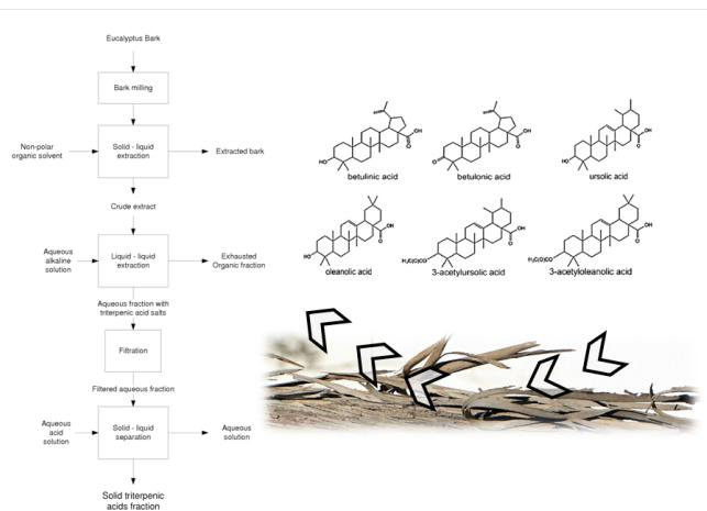
**Figure 1:** Sequence of operations involved in the extraction and purification of triterpenic acids from eucalypt bark. Sequência de operações envolvidas na extração e purificação de ácidos triterpénicos de casca de eucalipto.
