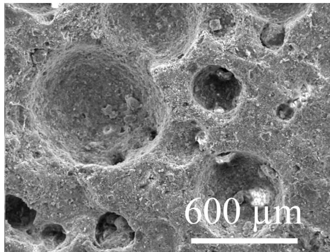
**Figure 1:** Photograph obtained by scanning electron microscopy, of the porous microstructure of the artifact (illustrating the micropores present). Fotografia obtida por microscopia eletrônica de varrimento, da microestrutura porosa do artefato (ilustrando os microporos presentes).
