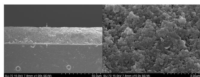
**Figure 2:** Microscopic view of deposited TiO<sub>2</sub> layer on ceramic substrates. Vista microscópica da camada de TiO<sub>2</sub> depositada sobre substratos cerâmicos.
