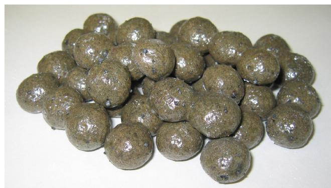
**Figure 1:** Lightweight aggregate produced with cellulose wastes. Agregado leve produzido com resíduos da indústria da celulose.
