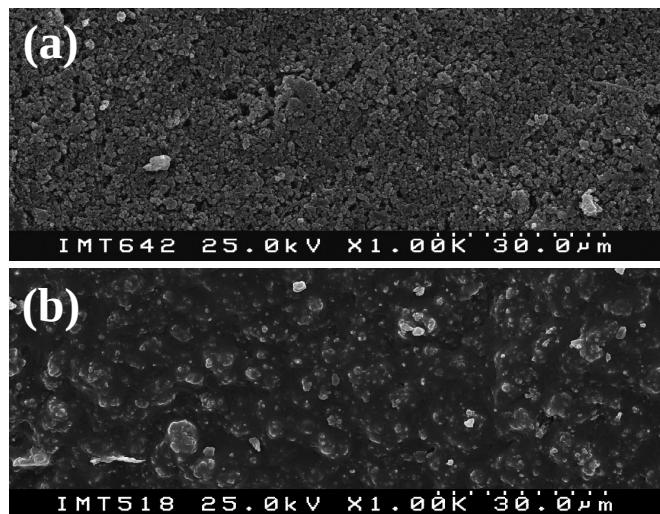
**Figure 1:** Microstructures observed by SEM of tapes obtained from a suspension containing 80 wt% solids, 1 wt% Dolapix CE 64 and 10 wt% Duramax 1080: (a) green tape; (b) tape after sintered (1000°C/2 hours). Microestructuras observadas por SEM de cintas obtidas a partir de uma suspensão contendo 80 wt.% de sólidos, 1 wt.% de Dolapix CE 64 e 10 wt.% de Duramax 1080: (a) cinta em verde; (b) cinta depois de sinterizada (1000°C/2 horas).
