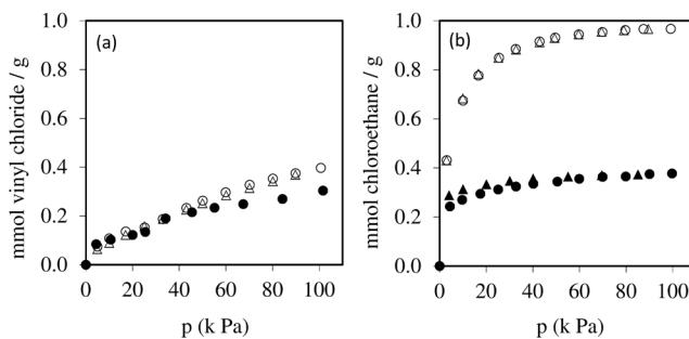
**Figure 1:** Adsorption (circles) and desorption (triangles) isotherms of vinyl chloride (a) or chloroethane (b) at 50 °C, for AlMepO-α (open symbols), and the benchmark adsorbent AlPO-14 (closed symbols). Isotérmicas de equilíbrio de adsorção (círculos) e dessorção (triângulos) de cloreto de vinilo (a) ou cloroetano (b) a 50 °C, para AlMepO-α (símbolos brancos), e o adsorvente de referência AlPO-14 (símbolos pretos).
