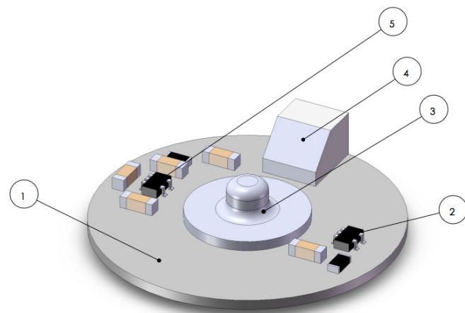
**Figure 1:** (1): Flexible substrate, (2: 4) electronic components mounted on top of the substrate (3) button to add the probe to the tissue, (5) electrode connector to the power supply and signal acquisition. Substrato flexível, (2, 4): componentes eletrónicas montadas na parte superior do substrato, (3) botão para agregar o eléctrodo ao tecido, (5) conector do eléctrodo à fonte de alimentação e aquisição de sinal.
