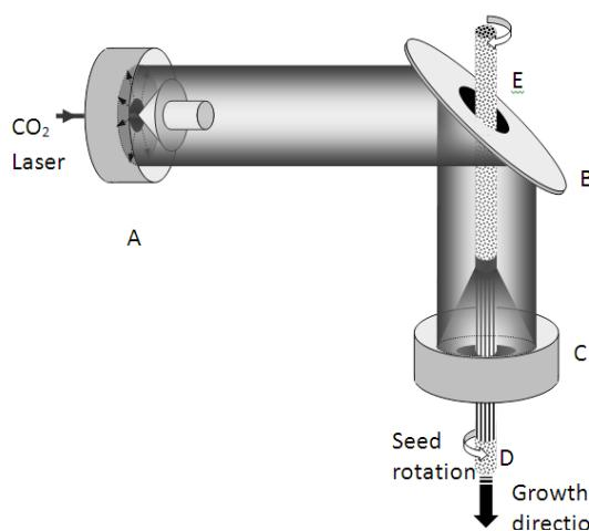
**Figure 1:** Schematics of the laser floating zone (LFZ) system. Esquema do sistema de fusão de zona com laser.
