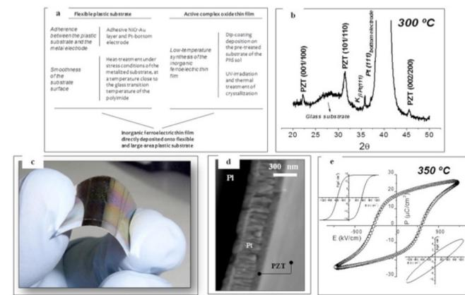
**Figure 1:** A novel solution method is developed that enables the processing of functional oxides under low-temperature conditions so that direct-large-area integration of active layers with flexible electronics is turned into reality. Um método de solução novo é desenvolvido permitindo o processamento de óxidos funcionais em condições de baixa temperatura para que a integração área-directa-grande de camadas ativas com com eletrónica flexível seja transformado em realidade.
