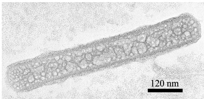
**Figure 1:** Image of a luminescent  $SrAl_2O_4: Ce^{3+}, Eu^{2+}, Dy^{3+}$  nanotube, i.e. strontium aluminate nanotube co-doped with lanthanide ions, obtained by transmission electron microscopy. Scale bar = 120 nm. Imagem de um nanotubo luminescente de  $SrAl_2O_4: Ce^{3+}, Eu^{2+}, Dy^{3+}$ , i.e. nanotubo de aluminato de estrôncio co-dopado com iões lantanídeos, obtida por microscopia eletrônica de transmissão. Escala = 120 nm.
