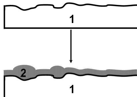
**Figure 2:** Schematic representation of selectively deposited LDHs films. LDHs formation of films (2) on metallic substrates (1). Representação esquemática dos filmes de HDLs selectivamente depositados. Formação de filmes de HDLs (2) em substratos metálicos (1).
