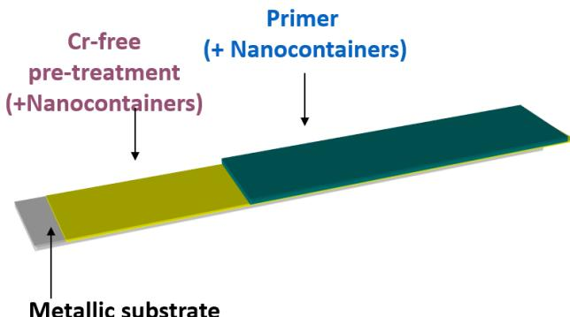
**Figure 1:** Coating a metal surface comprising pretreatment with nanocontainers and primer impregnated with nanocontainers. Revestimento de uma superfície metálica composto por pré-tratamento com nanocontentores e por primário impregnado com nanocontentores.
