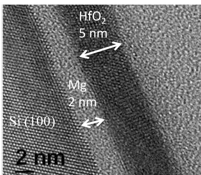
**Figure 1:** Image from SEM highlighting an 2nm Mg interlayer between an (100) silicon substrate and an 5nm hafnium oxide layer. Imagem obtida por SEM destacando uma intercamada de Mg de 2nm entre um substrato de silício (100) e uma camada de óxido de hafnio de 5nm.
