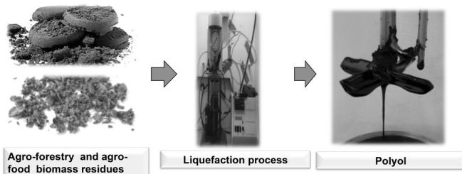
**Figure 1:** Scheme illustrating the production of liquid polyols by liquefaction of biomass (residues). Esquema ilustrando a produção de polióis líquidos por liquefação de biomassa (resíduos).
