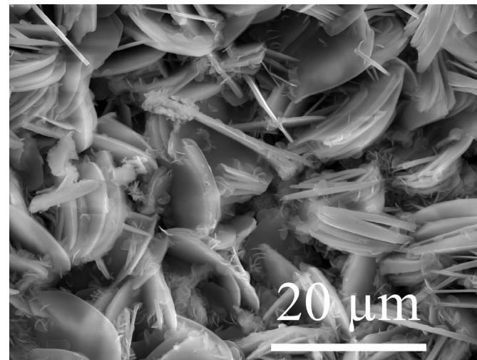
**Figure 2:** Photograph obtained by scanning electron microscopy, of the porous microstructure of the artifact (illustrating the inter-crystalline nanopores present). Fotografia obtida por microscopia eletrônica de varrimento, da microestrutura porosa do artefato (ilustra os nanoporos intercristalinos presentes).
