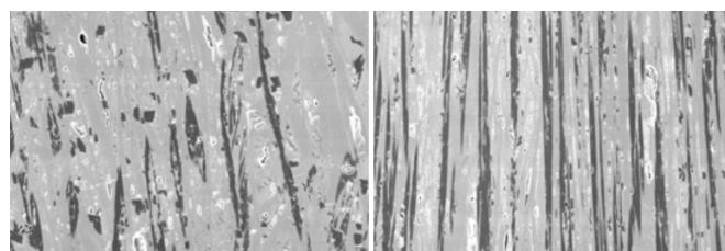
**Figure 1:** Bi-Sr-Ca-Cu-O system by (left) Laser-Floating-Zone (LFZ) and (right) Electrical Assisted Laser Floating Zone (EALFZ). Sistema Bi-Sr-Ca-Cu-O (à esquerda) por fusão de zona com laser (LFZ) e (à direita) por fusão de zona com laser assistida por corrente eléctrica.
