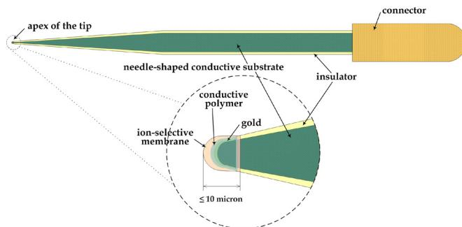
**Figure 1:** Ion-selective solid contact microelectrode. Microeléctrodo selectivo de iões de contacto sólido.
