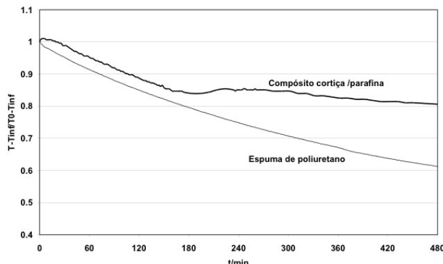
**Figure 1:** Comparison between the cooling profile of the cork/paraffin composite vs. polyurethane foam insulation material. Comparação dos perfis de arrefecimento do compósito cortiça/parafina com o de um isolante térmico baseado em espuma de poliuretano.
